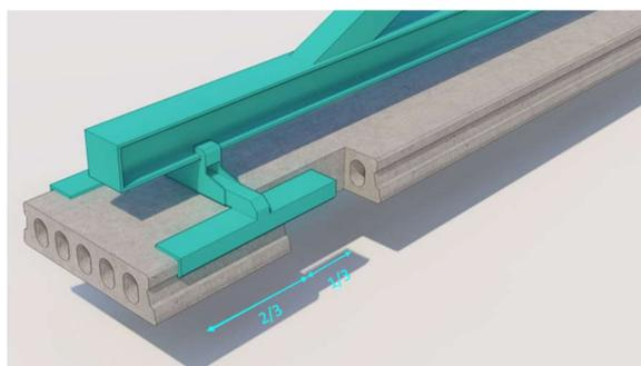
Pour les éléments avec évidements, il est indispensable que la pince agrippe le béton sur au minimum  $\frac{2}{3}$  de la pince
